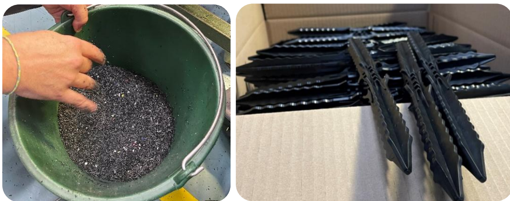
Figure 18 : A gauche - broyat de 6 mm environ, A droite - taquets à moules produits avec du broyat de poches
